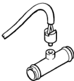
Термостат вентилятора в контуре охлаждающей жидкости
